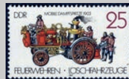
Abb. 3: DDR 1987 Eine selbstfahrende mobile Dampfspritze mit seitlichen Saug- und Druckanschlüssen. Hersteller Fa. W.C.F. Busch AG Bautzen, Baujahr 1903.
