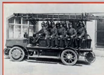
Abb. 6: Basel/Wien Eine Postkarte zeigt Mannschafts- und Gerätewagen der Feuerwache Basel von 1905–1930. Elektroantrieb mit Radnabenmotoren: System Lohner-Porsche. Chassis: k.u.k. Hof-Wagenfabrik Jakob Lohner & Cie., Wien. Aufbau: Preiswerk, Esser & Cie., Julius Kölz, Basel.
